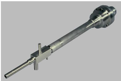
► Радиоактивные эжекторы (термодинамические насосы без подвижных деталей), разработанные для исключения потенциального риска облучения радиоактивными материалами, демонтируемые под MERC, разработанные для передачи коррозионных и радиоактивных жидкостей. В Гаагу поставлено около 2500 эжекторов.
