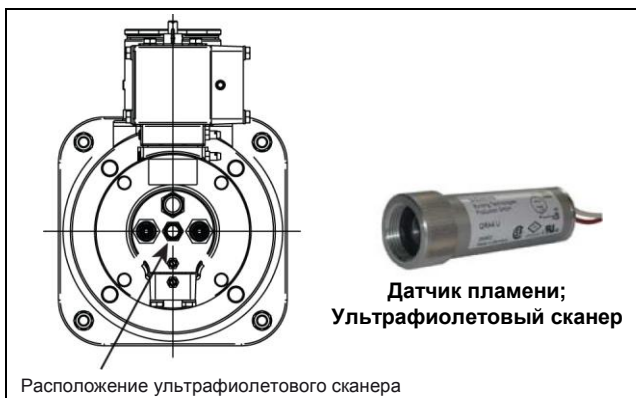
Рис. 3.10 Установка ультрафиолетового сканера
