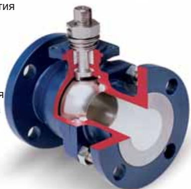
Durco ® Microfinish ™ металлические шаровые краны Корпус из двух частей С редуцированным и полным проходом ANSI класс 150 и 300 Огнестойкий Более высокие классы давления и металлическое уплотнение - по запросу
