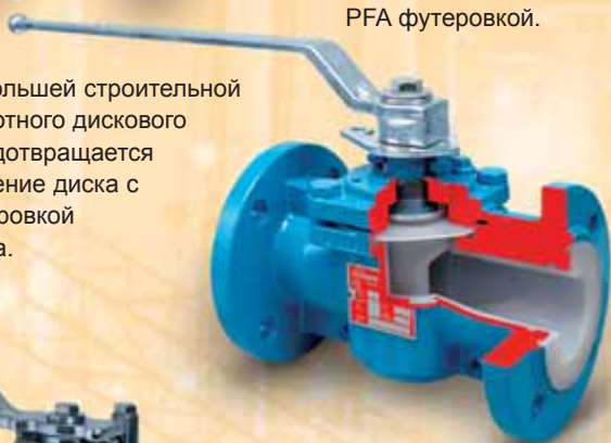
T4E PFA новое поколение пробковых кранов с PFA – футеровкой. в распоряжении имеются краны согласно стандартам: ANSI класс 150 и 300, DIN Py 16, регулировочным конусом.
