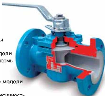
T4E PFA футерованные пробковые краны Стандартные модели T4E1 – ANSI класс 150 T4E2 – DIN Py 16 бар T4E3 – ANSI класс 300
