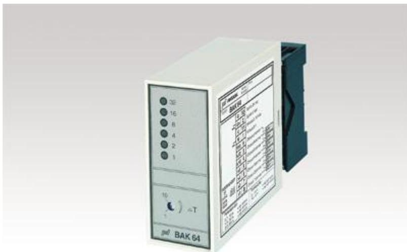
Бинарный 6-ступенчатый контроллер мощности электрического отопления. Может быть использован во всех системах с сигналом выхода 0-10V. Реле AR1 или RY1 нужны для обеспечения выходных контактов. Ступени должны быть вinarной последовательности, например 1,2,4,8,16,32 kW.
