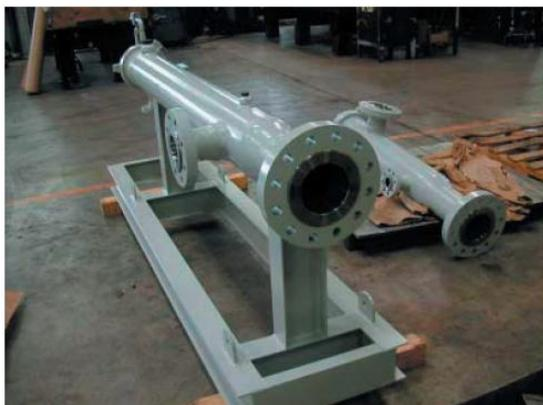
Разработка и производство компанией Sweco Fab, Inc. камер пуска и приема очистных скребков по заказу одной из нефтегазопромысловых и добывающих компаний в Венесуэле
