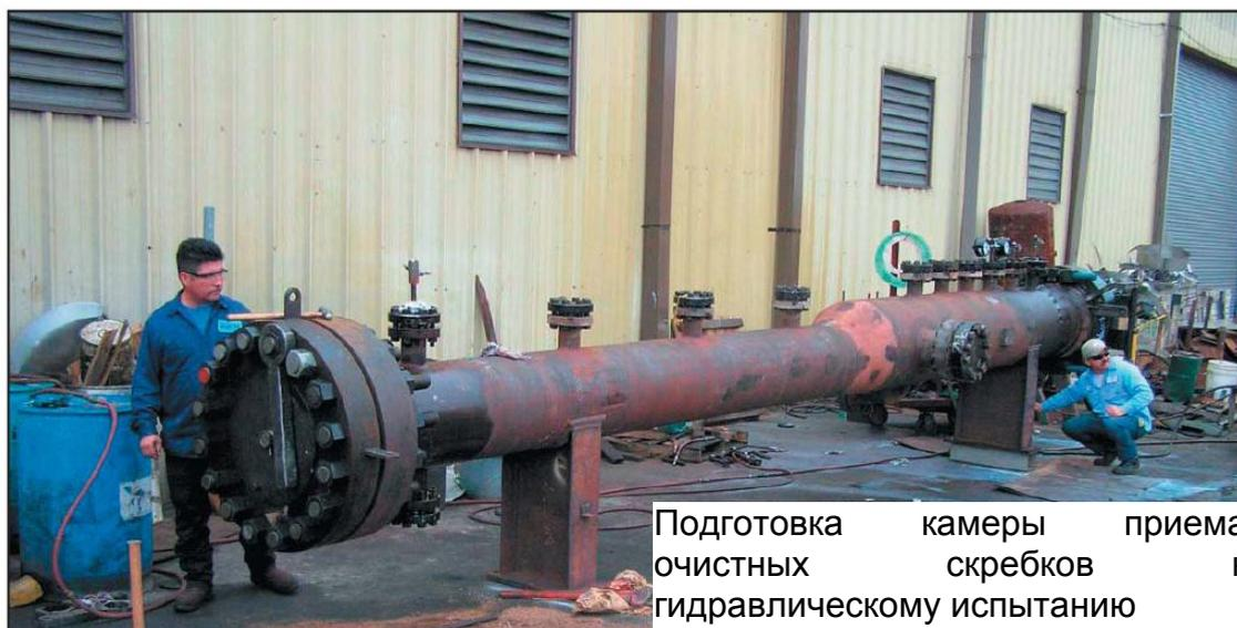
Подготовка камеры приема очистных скребков к гидравлическому испытанию
