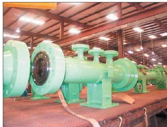
Разработка и производство компанией Sweco Fab, Inc. камер пуска и приема очистных скребков диаметром 24 x 30 дюймов (609,6 x 762 мм) для работы под давлением 740 PSI изб. для установки на НПЗ в Мексике.
