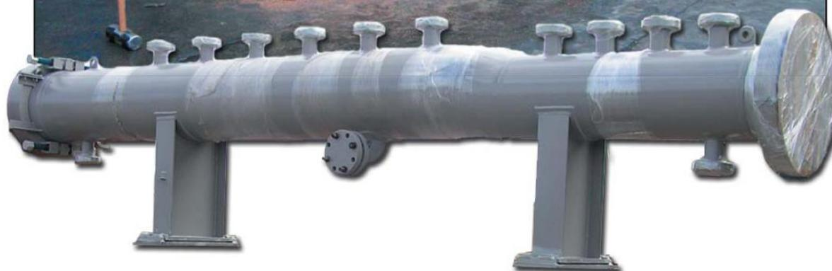
Камера пуска очистных скребков готова к отгрузке.
