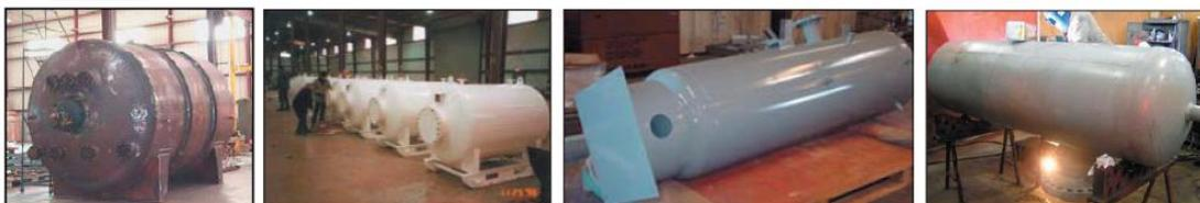
**КАМЕРЫ ПУСКА И ПРИЕМА ОЧИСТНЫХ СКРЕБКОВ**
