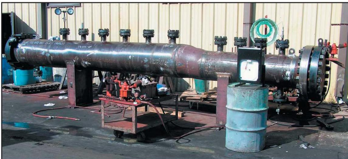
Камеры пуска и приема очистных скребков прошли гидравлические испытания. В ходе испытаний каждая камера заполняется водой, после чего давление постепенно повышается до достижения указанного значения. На протяжении четырех часов испытания под таким высоким давлением значение давления отслеживалось с помощью расходомера.
