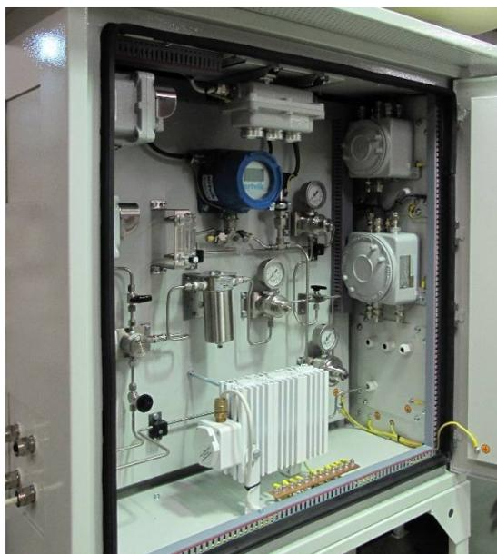
Растворенные в металле атомы водорода, меняют его электронные свойства. Поэтому появляется возможность связать относительное изменение измеряемых проводимости и емкости металла с концентрацией водорода в металле, следовательно, с его концентрацией в газе.
