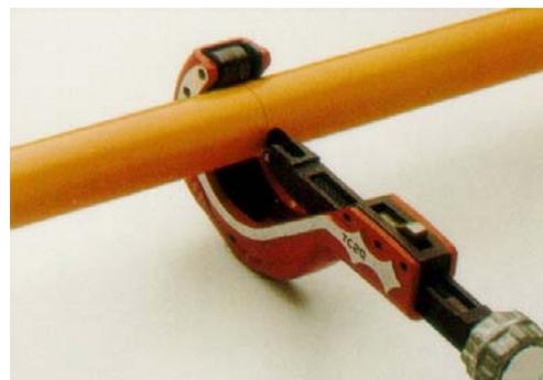
Работая резаками с храповым механизмом, старайтесь не расщепить трубу. Нарушение этих требований может привести к разрушению трубы и протечке. Резаки с храповым механизмом применяются только при температурах от 10 °С и выше.
