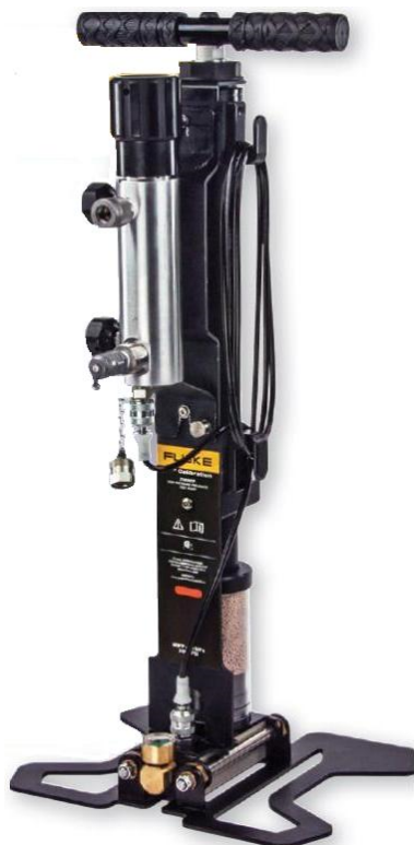
700HPPK; 700HPP (без коллектора) 0...21 МПа воздух, 7,2 кг; 5,5 кг; 660x250x130 мм выход: 2 x 1/4" NPT F быстроразъемное, комплект переходников, шланг
