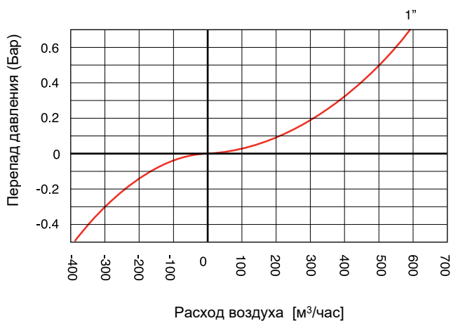
Расход воздуха при кинетическом сбросе
