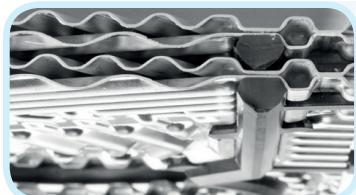
Такая конструкция исключает возможность возникновения течей теплоносителя, находящегося в сварных каналах. При этом полусварной теплообменник повторяет конструкцию разборного и имеет все его преимущества, включая возможность увеличения мощности, механической очистки поверхности пластин и т.п.
