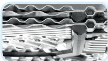
Такая конструкция **исключает возможность возникновения течей теплоносителя**, находящегося в сварных каналах. При этом полусварной теплообменник повторяет конструкцию разборного и имеет все его преимущества, включая возможность увеличения мощности, механической очистки поверхности пластин и т.п.
