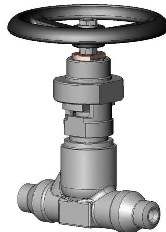
Запорный клапан, вращающийся выдвигной шпindelь, безасбестовое сальниковое и плоское уплотнения, тип корпуса прямой и угловой, исполнение под приварку, с патрубками, с винтовым соединением.
