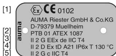
рис. 4: Сертификационная табличка. Исполнение во взрывозащищенном корпусе
